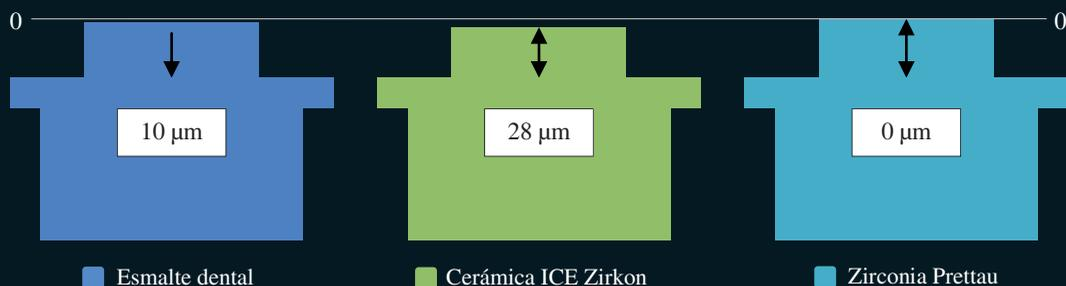
*Representación esquemática del efecto abrasivo de las distintas muestras sobre el cuerpo de fricción después de 3,024 millones de ciclos de contacto.*
